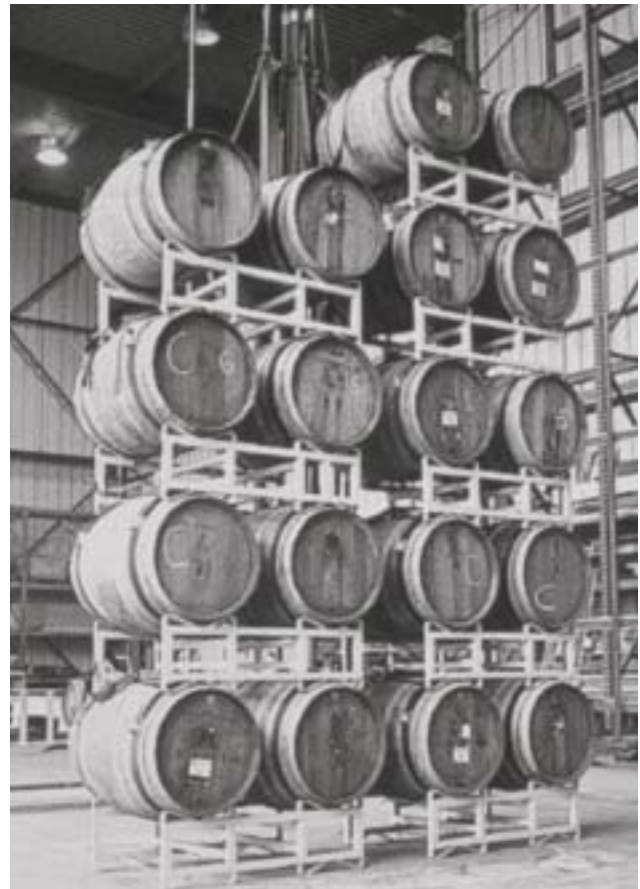
35/9 Und sogar Lagergestelle für Weinfässer können auf einem Erdbbensimulator («Rütteltisch») geprüft werden... (Berkeley 2000).
